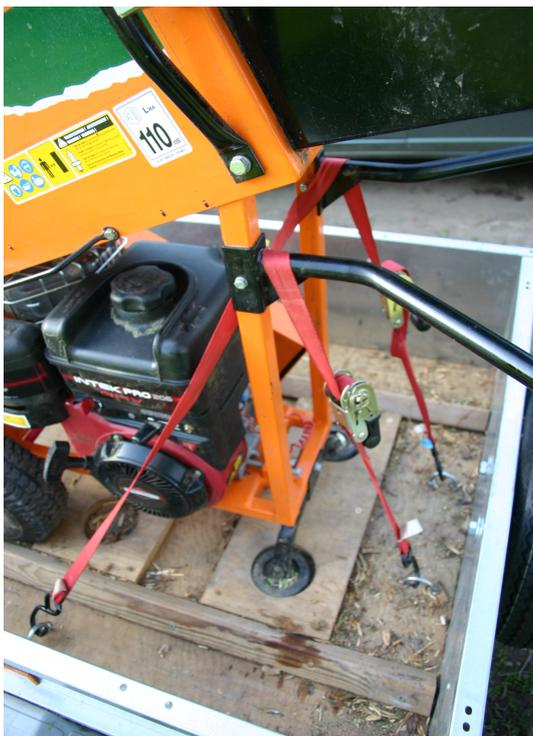
**2- et une sangle croisée sur l'essieu arrière** (surtout ne pas sangler la cage de protection arrière)...
