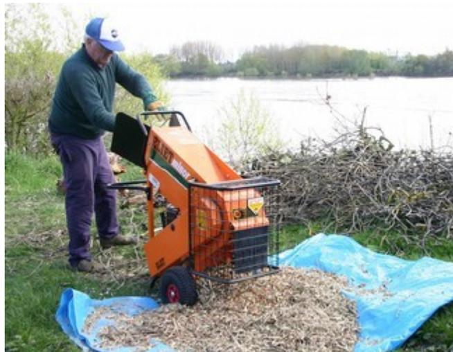
*Rendement possible de 1 m<sup>3</sup> de broyat en 2 heures.... Ne pas bourrer inutilement la machine et la chambre de broyage, il faut laisser le temps au rotor de digérer le broyat par les trous du carter, sinon risque de blocage et grosse perte de temps...*
